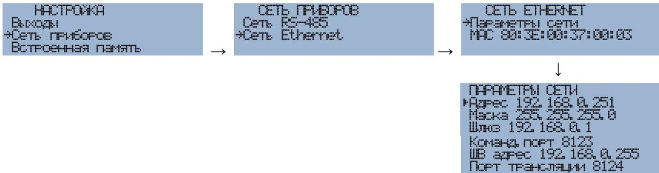
Рисунок 15. Настройка параметров Ethernet.
