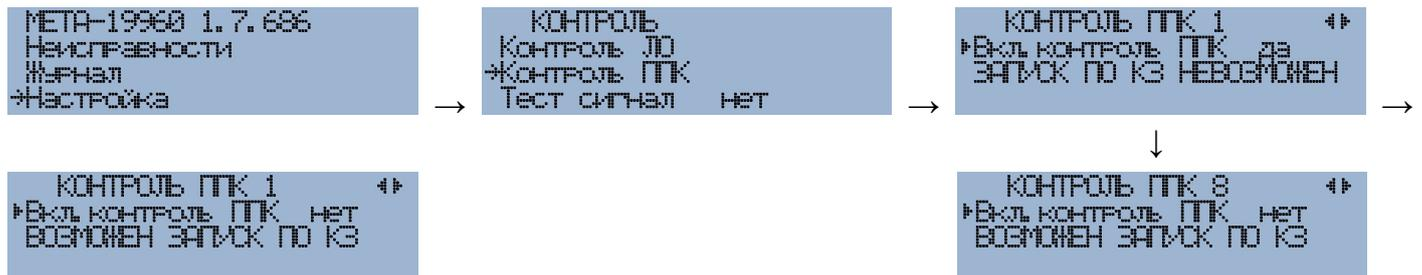
Рисунок 8. Включение / отключение контроля по шлейфам ПС.
