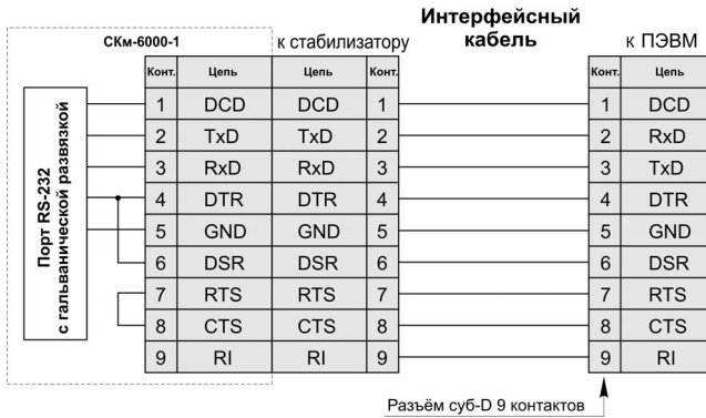
Рисунок 7 – Схема электрическая соединения стабилизатора с ПЭВМ
